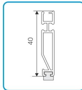
Endschiene mit Magnet 40mm
