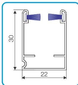
Führungsschiene oben 30x22mm
