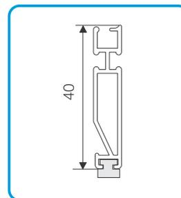
Endschiene mit Magnet 40mm
