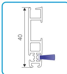
Gewebeschiene mit Bürstendichtung 40mm
