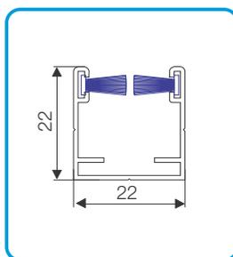
untere Führungsschiene 22x22mm
