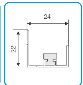
Anschlagprofil mit Magnet 22x24mm
