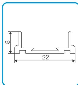
untere Führungsschiene 8x22mm
