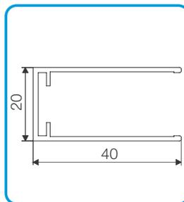
Führungsschiene oben 20x40mm
