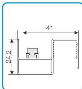
Anschlagprofil mit Magnet 41x24,2mm
