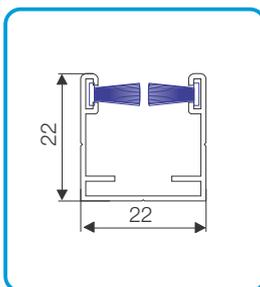
untere Führungsschiene 22x22mm
