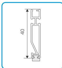
Endschiene mit Magnet 40mm
