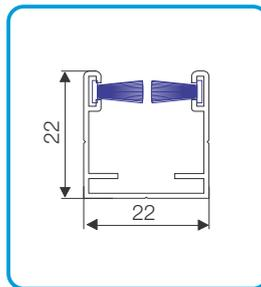
untere Führungsschiene 22x22mm
