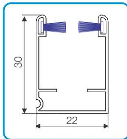
Führungsschiene oben 30x22mm
