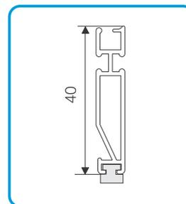
Endschiene mit Magnet 40mm
