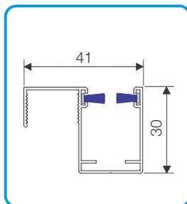
Führungsschiene oben 41x30mm
