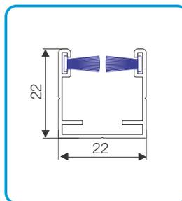
untere Führungsschiene 22x22mm
