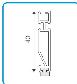
Endschiene mit Magnet 40mm
