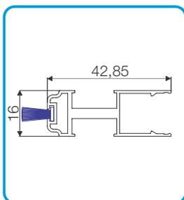
Gewebeschienen mit Bürstendichtung
