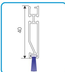
Gewebeschiene mit Bürstendichtung 40mm
