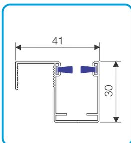
Führungsschiene oben 41x30mm
