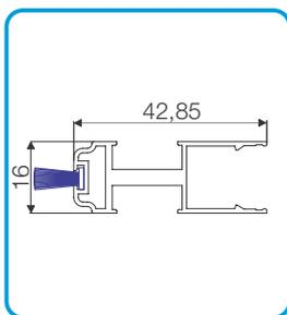
Gewebeschienen mit Bürstendichtung
