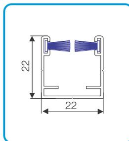
untere Führungsschiene 22x22mm
