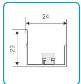
Anschlagprofil mit Magnet 22x24mm
