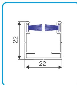
untere Führungsschiene 22x22mm
