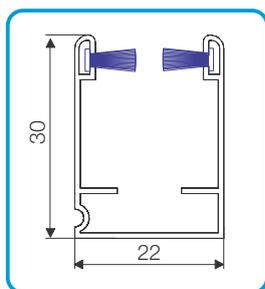
Führungsschiene oben 30x22mm
