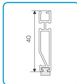
Endschiene mit Magnet 40mm
