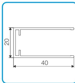
Führungsschiene oben 20x40mm
